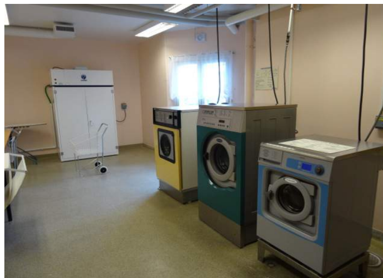
I denna tvättstuga är maskinen längst till höger tillgänglig från rullstol, då den är frontmatad och har knappsatser som är tillräckligt låga.
